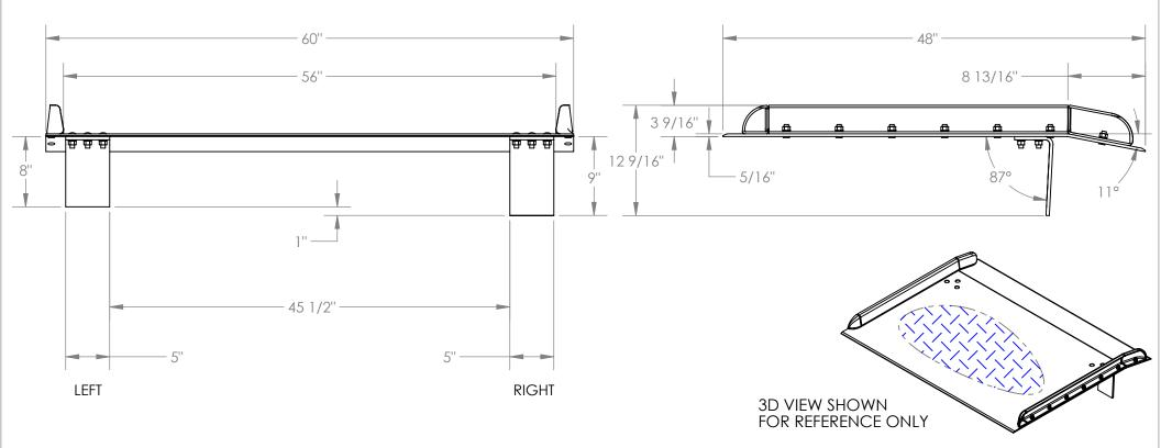
LEGS: RIGHT LEG IS 9" LG, LEFT LEG IS 8" LG. LEGS ARE UNEVEN TO CREATE A GAP SO DOCKBOARD CAN BE PICKED UP BY A FORK LIFT
