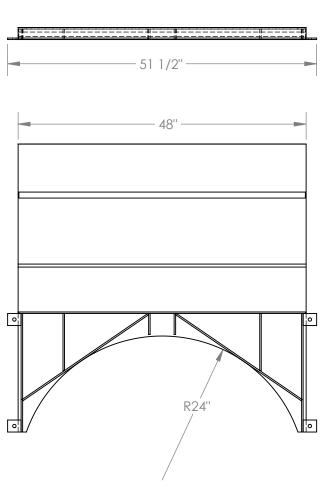
STANDARD FEATURES **MODEL NUMBER IS SWA-R-4848 OVERALL LENGTH IS 48" OVERALL HEIGHT IS 2" OVERALL WIDTH IS 51 1/2" USABLE WIDTH IS 48"** MAX CAPACITY IS: 4,000 LBS.
