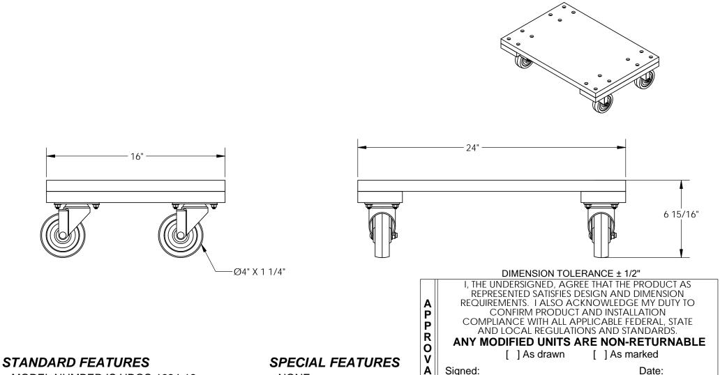
MODEL NUMBER IS HDOS-1624-12 OVERALL WIDTH IS 16" USABLE WIDTH IS 16" OVERALL LENGTH IS 24" USABLE LENGTH IS 24" OVERALL HEIGHT IS 6 15/16" MAX CAPACITY IS 1,200 LBS. 4X Ø4" X 1 1/4" HARD RUBBER SWIVEL CASTERS
