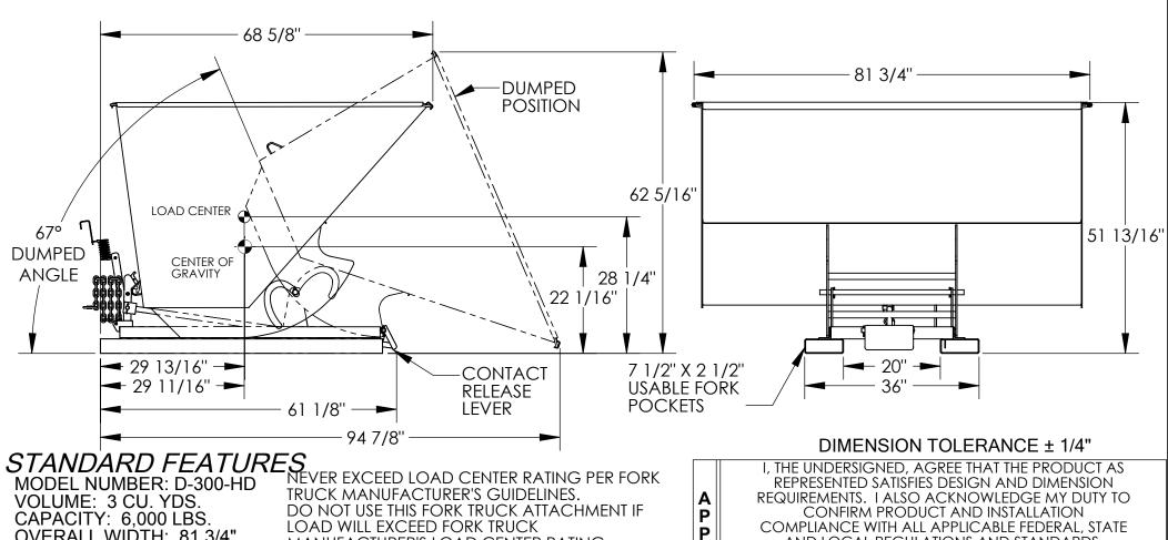
OVERALL WIDTH: 81 3/4" **OVERALL LENGTH: 68 5/8"** OVERALL HEIGHT: 51 13/16" PULL CABLE IS AT LEAST: 48" TOUGH BAKED IN POWDER **COATED BLUE FINISH**
